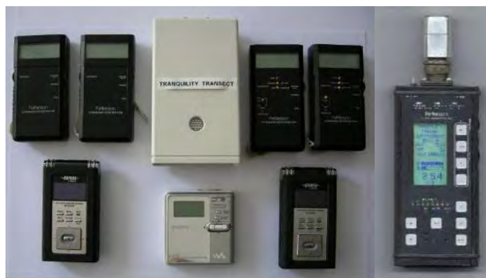
Photo 65: Détecteurs-amplificateurs d'ultrasons et enregistreurs numériques utilisés lors de l'étude
